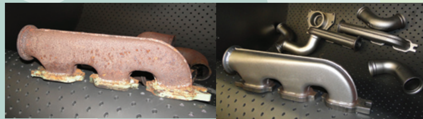
Uitlaat van een motor van een pantserrupsvoertuig voor en na stralen. De trommel van 400 liter kan een maximum van 500 kilo aan werkstukken tegelijk verwerken.
