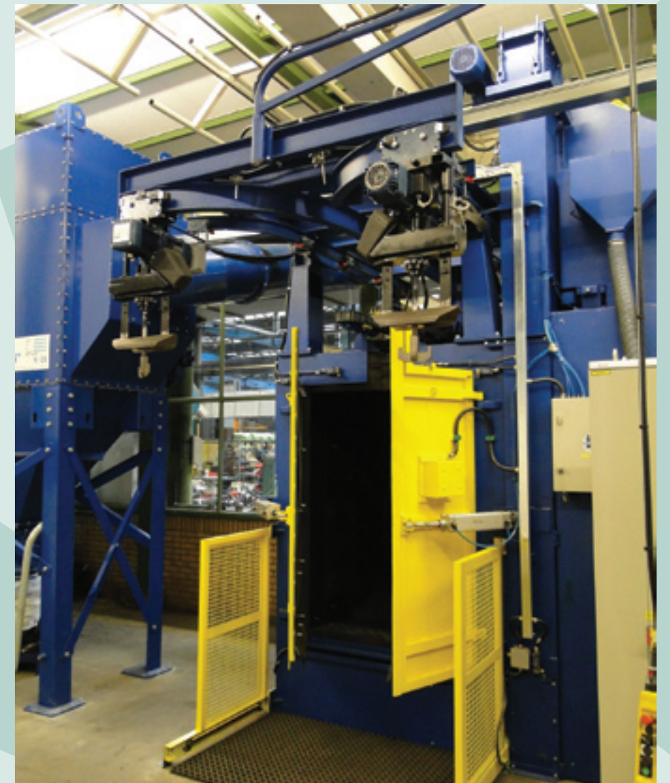
De hangbaan met takels is een grote vooruitgang in het werkgemak. De deuropening is 1.500 X 2000, maximum laadgewicht 500 kilo.
