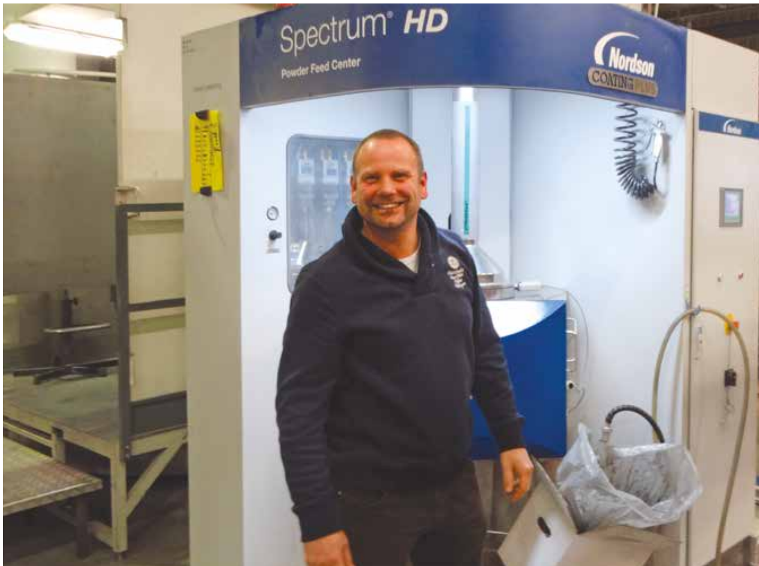
Edwin Beuk (Nordson) bij een poedercabine met ultrasoonzeef, die vlotjes “vanuit de doos” een korte serie kan draaien.
