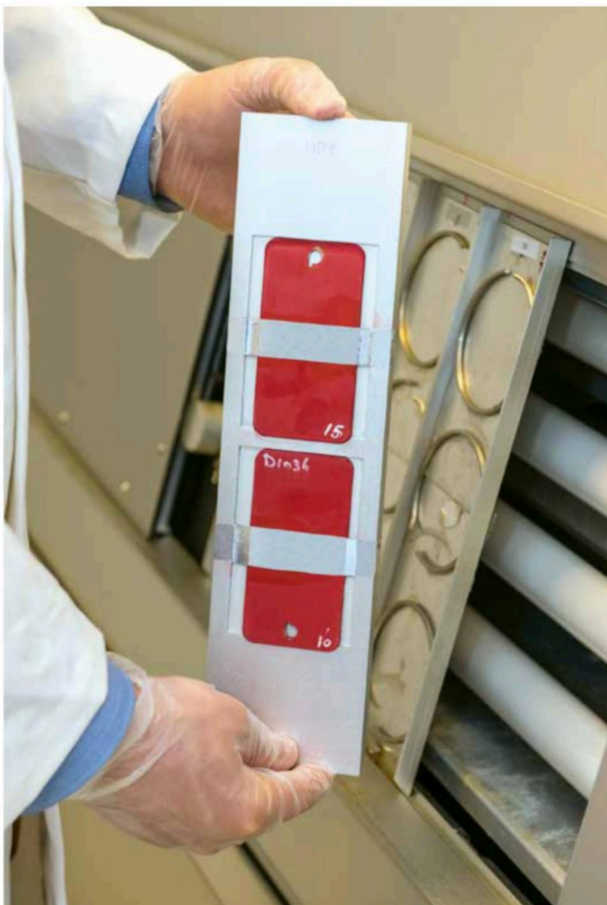
Testplaatjes in de houder bij de QUV-test. (foto: Coating Advies Nederland)
