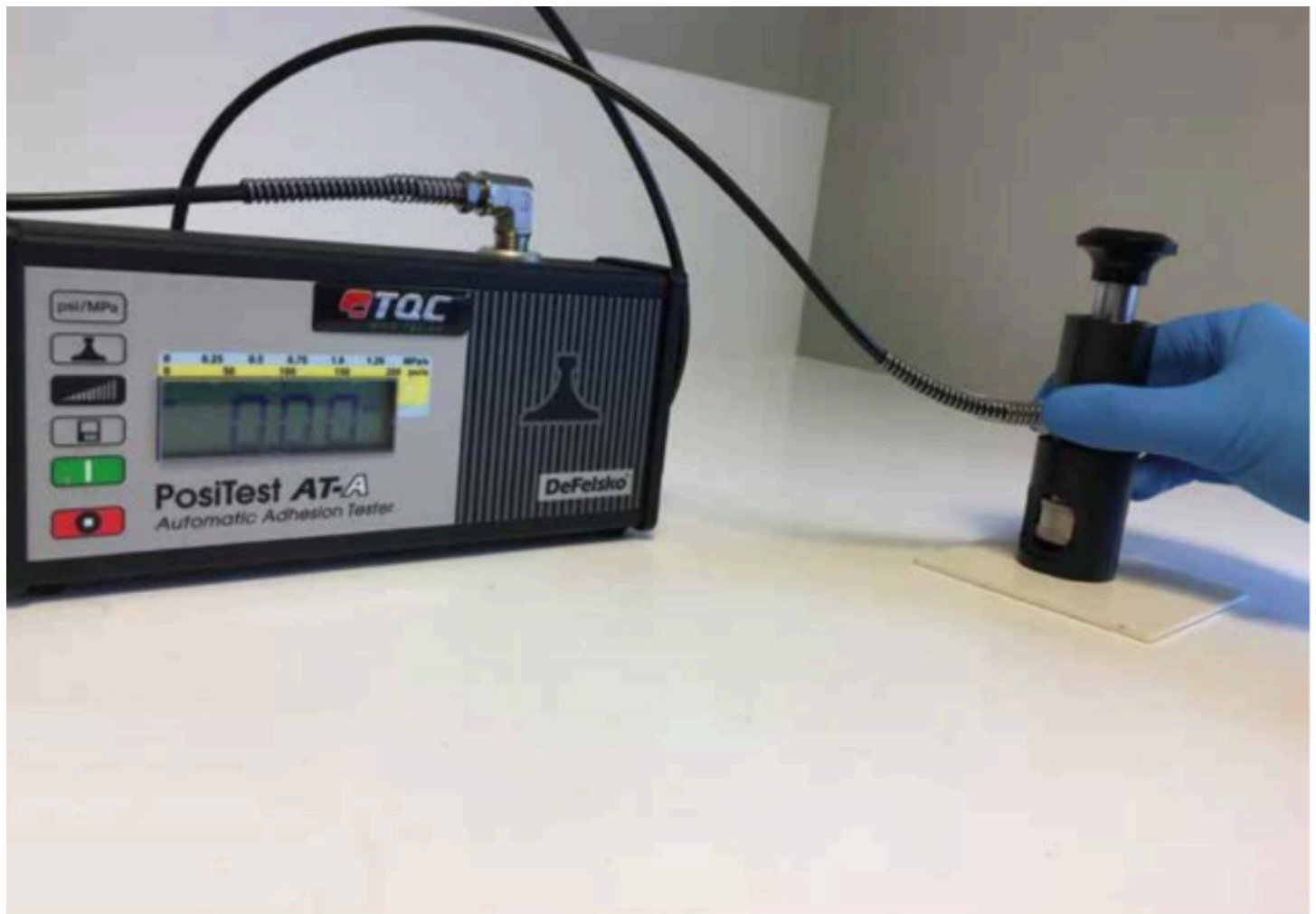
Bepaling van de hechtingssterkte met behulp van de pull off test. (foto: Coating Advies Nederland)
