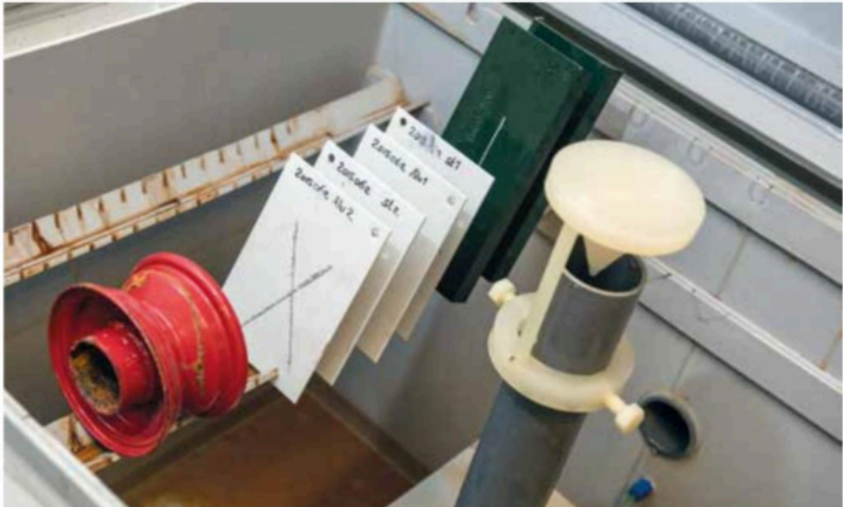
Producten in de zoutsproeitest om corrosiewering te testen. (foto: Coating Advies Nederland)
