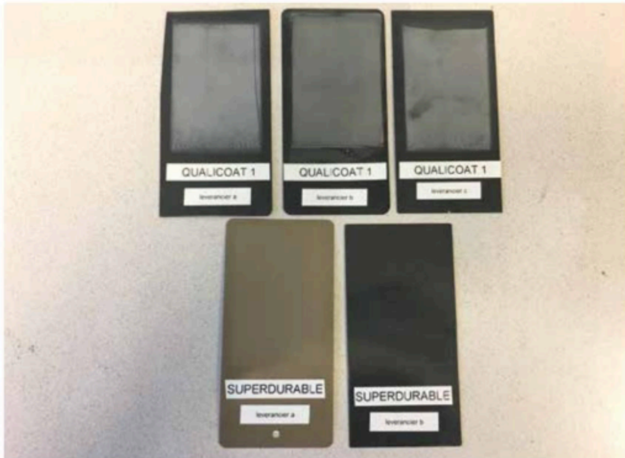
Verschillende poedercoatings na 1.500 uur QUV-test. (foto: Coating Advies Nederland)
