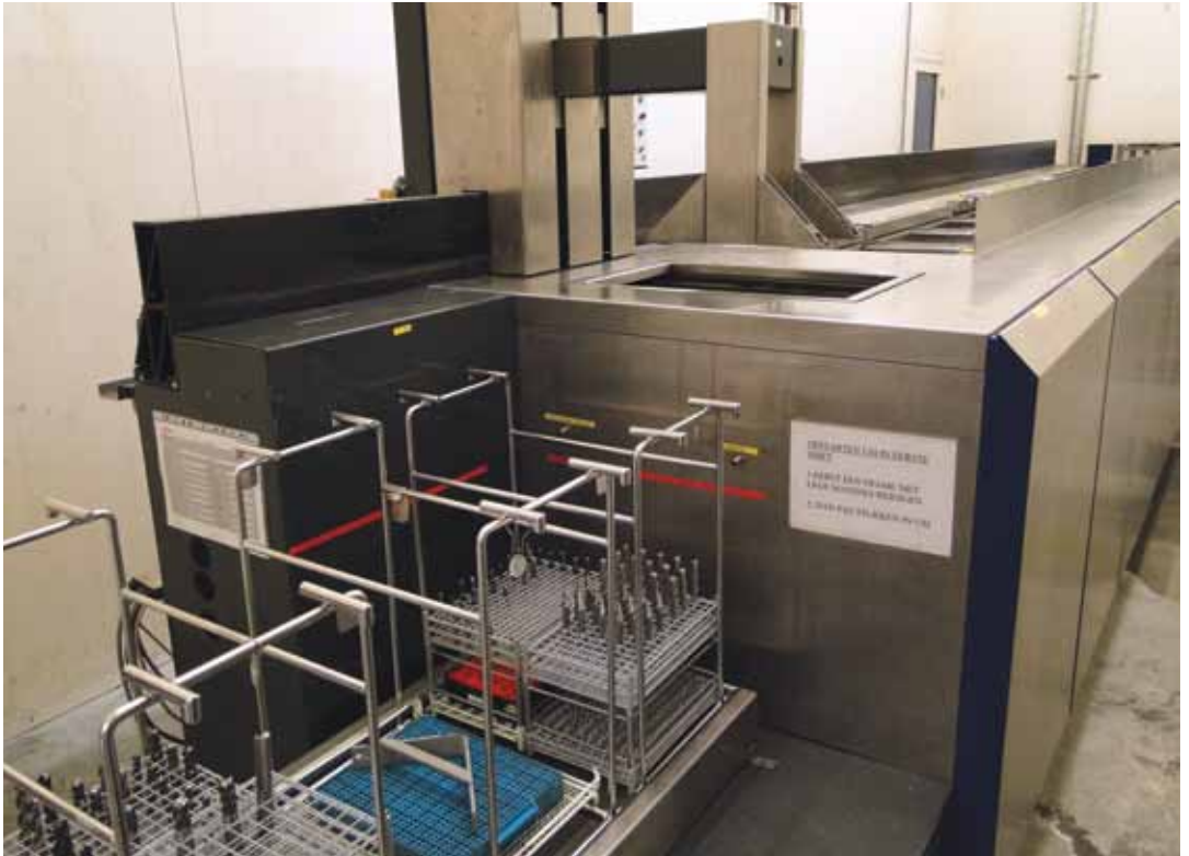
Reinigen: de essentiële voorbehandeling voorafgaand aan het depositieproces.
