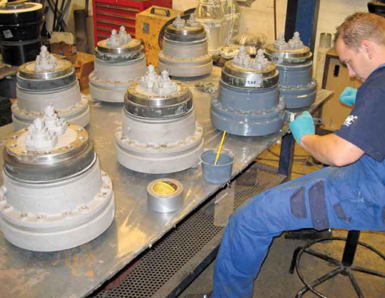
De hoogwaardige coating wordt zowel in spuit- als kwastapplicatie toegepast. (Foto: Saedt BV, Amsterdam)
