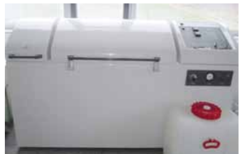
Zoutsproeikast voor corrosietesten. De test (ISO 9227/ASTM B-117) heeft geen voorspellende waarde, maar leent zich dankzij de enorme hoeveelheid historische data voor onderlinge vergelijking van coatingsystemen. (Foto: Institut für Oberflächentechnik, Duitsland)
