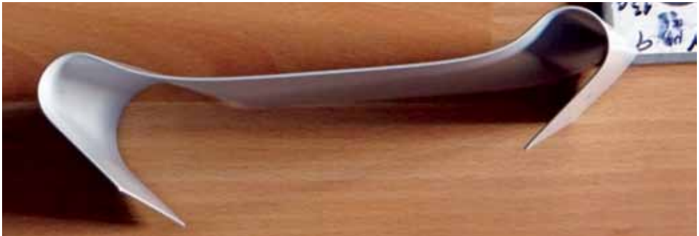
Gebogen proefplaat, om de flexibiliteit van de coating te bepalen. De plaat wordt rond een taps toelopende torn gedraaid, waarna vastgesteld wordt vanaf welke diameter de lak de bocht niet meer kan volgen en het begeeft.
