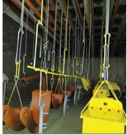
Dikwandig materiaal hangt te drogen; helemaal linksboven een IR-straler.
