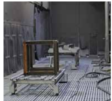
Stralen voorafgaand aan het coaten: een schoon oppervlak en een goed ankerprofiel zijn bepalend voor de lakhechting.
